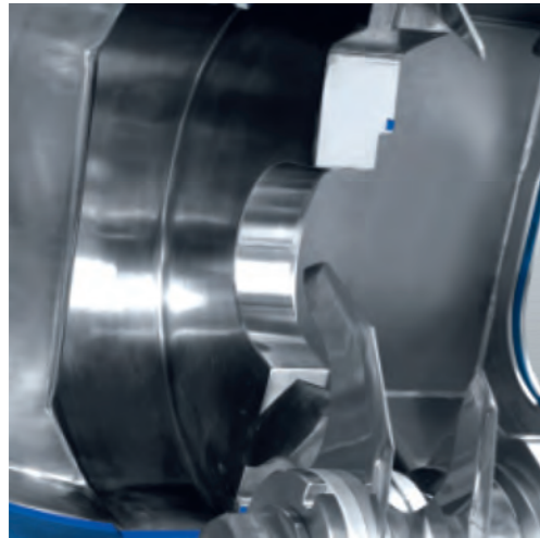
NARROW KNIFE COVER FOR IMPROVING THE QUALITY OF MEAT STUFFING TAPA DE CUCHILLAS ESTRECHA PARA MEJORAR LA CALIDAD DE RELLENO DE CARNE
