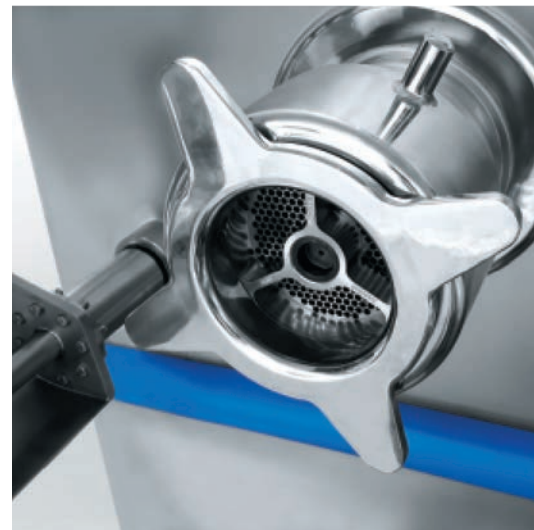
QUICK RELEASE NUT ALLOWS EASY AND QUICK REPLACEMENT OF CUTTING SET TUERCA RÁPIDA ASEGURA RECAMBIO FÁCIL Y RÁPIDO DE LAS HERRAMIENTAS DE CORTE
