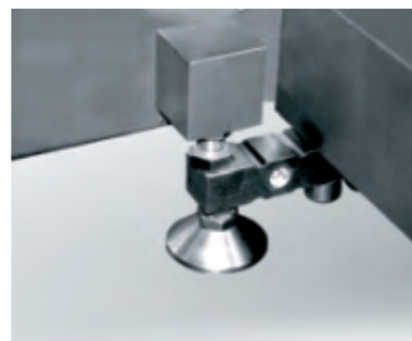
weighing system in tumblers sistema de pesaje en los bombos
